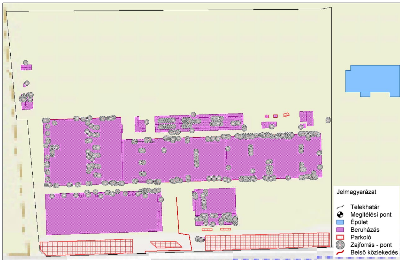
44. ábra A tervezett zajforrások elhelyezkedése
